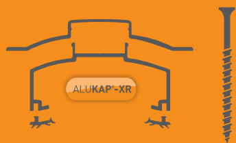
Options de joints de chevrons pour les profilé de arêtier et profilé faitière Alukap®-XR :
